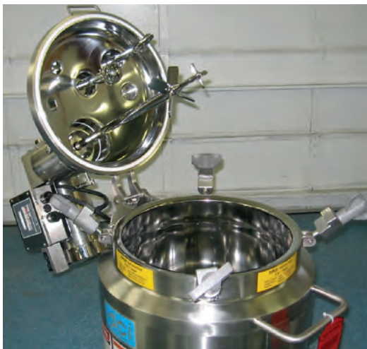
图1 采用厚度标号为10的2205双相不锈钢板和3/16英寸（4.8毫米）厚的2205双相不锈钢板制造的制药行业用研发容器。与产品接触的表面经电解抛光使光洁度达到ASME BPE - SF4。（照片来源：Genentech）
