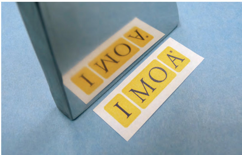
图7 电解抛光的2205双相不锈钢板（样品来源：DCI公司）
